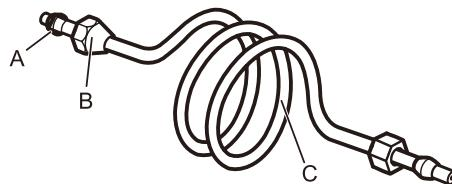
A. Manguito de compresión C. Tubo de cobre
