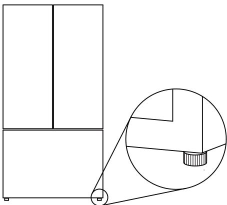
4. Utilisez un ustensile ménager courant afin de soulever légèrement le réfrigérateur pour pouvoir régler facilement le pied de mise de niveau.
