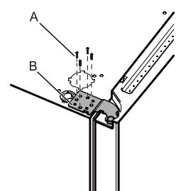
A. Vis à douille de 5 mm
