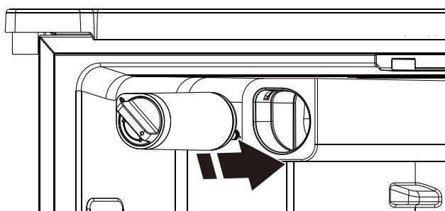
7. Tournez le bouton de verrouillage dans le sens horaire sur 180° pour maintenir le filtre verrouillé.
