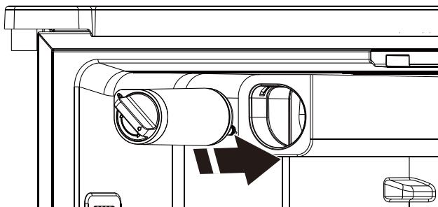
7. Gire el control de bloqueo 180° en sentido horario para mantener el filtro bloqueado.
