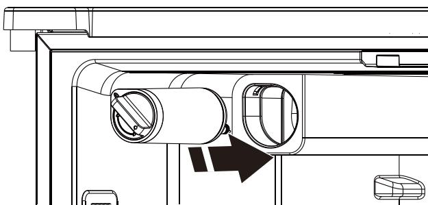
5. Tournez le bouton de verrouillage dans le sens horaire sur 180° pour maintenir le filtre verrouillé.
