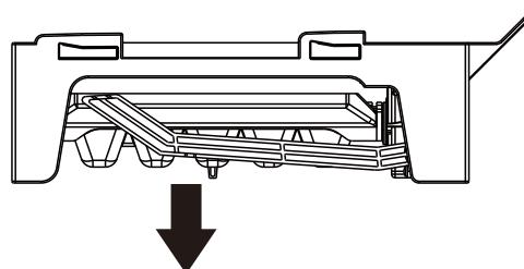
**NOTA:** Apague la máquina de fabricación de hielo antes de retirar el depósito de almacenamiento de hielo para servir hielo o limpiarlo. Esto evitará que los cubitos se caigan de la máquina de fabricación de hielo al compartimento del congelador. Después de volver a colocar el depósito de almacenamiento de hielo, encienda la máquina de fabricación de hielo. Lave el depósito de almacenamiento de hielo con jabón suave y agua tibia.
