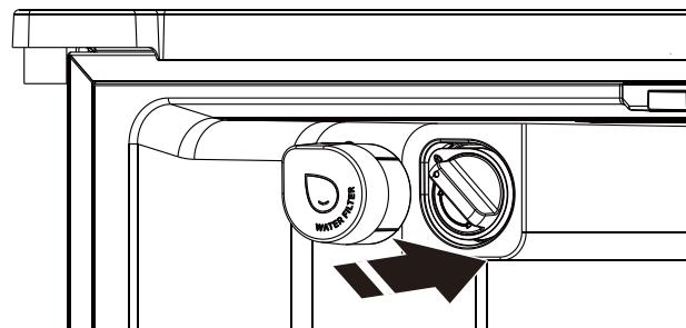
**REMARQUE :** Si le filtre n'est pas installé correctement, le débit de l'eau peut inférieur et la production de glace plus lente. Une installation incorrecte du filtre peut également entraîner une fuite du boîtier du filtre à eau.
