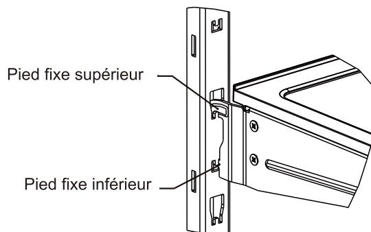
**REMARQUE :** Le trou 1 ne peut être utilisé que pour le support de la demi-clayette gauche et le trou 2 ne peut être utilisé que pour le support de la demi-clayette droite. S'il est mal placé, la clayette est instable et ne peut pas être utilisée.
