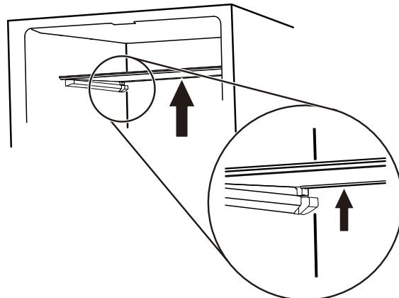
2. Desplace la balda de cristal hacia delante y baje la balda delantera hasta que el embellecedor trasero quede fuera de los soportes.
