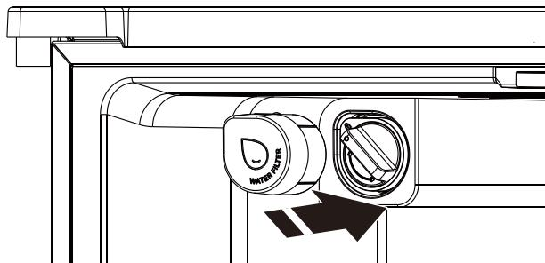
**NOTA:** Si el filtro no está instalado correctamente, el agua puede dispensarse con un caudal menor y la fabricación de hielo será más lenta. Una instalación incorrecta del filtro también puede provocar fugas en la carcasa del filtro de agua.
