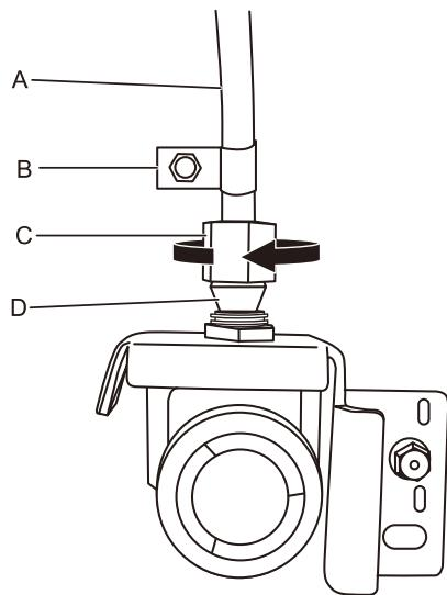
A. Tubo de cobre      C. Tuerca de compresión
