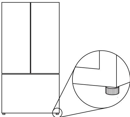
4. Utilice una herramienta doméstica común para levantar el frigorífico un poco y ajustar la pata niveladora fácilmente.
