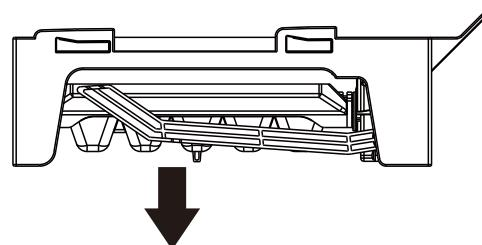
**REMARQUE :** Désactivez la machine à glaçons avant de retirer le bac à glaçons pour servir des glaçons ou pour nettoyer le bac. Cela empêche les glaçons de tomber de la machine à glaçons dans le compartiment congélateur. Après avoir remis en place le bac à glaçons, activez la machine à glaçons.
