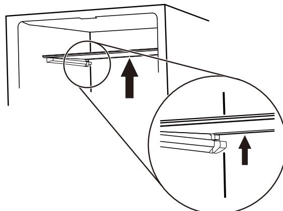
2. Déplacez la clayette en verre vers l'avant et abaissez la clayette avant jusqu'à ce que la garniture arrière soit hors des supports.
