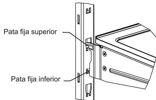
**NOTA:** El orificio 1 solamente se puede utilizar para el soporte de la media balda izquierda y el orificio 2 únicamente se puede utilizar para el soporte de la media balda derecha. Si se colocan incorrectamente, la balda será inestable y no se podrá utilizar.
