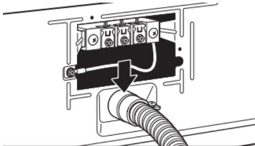
Passer le câble à raccordement direct à travers le serre-câbles. Le serre-câbles doit être bien relié à la caisse de la sècheuse et se trouver en position horizontale. Serrer la vis du serre-câbles autour du câble à raccordement direct.
