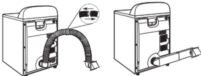
Installation au-dessus de la sècheuse (également offerte avec un coude décalé)      Installation en pénétration
