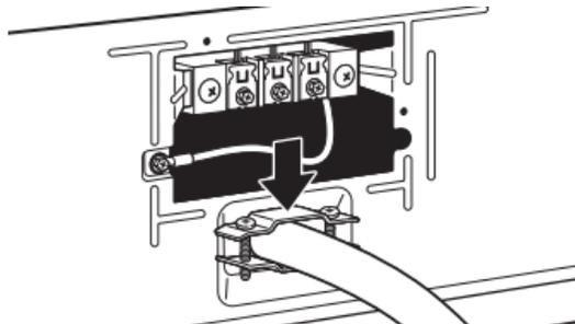
Passer le cordon d'alimentation à travers le serre-câbles. Vérifier que la gaine d'isolement du cordon d'alimentation rentre à l'intérieur du serre-câbles. Le serre-câbles doit être bien relié à la caisse de la sècheuse et se trouver en position horizontale. Serrer la vis du serre-câbles autour du cordon d'alimentation. Ne pas serrer excessivement les vis du serre-câbles.
