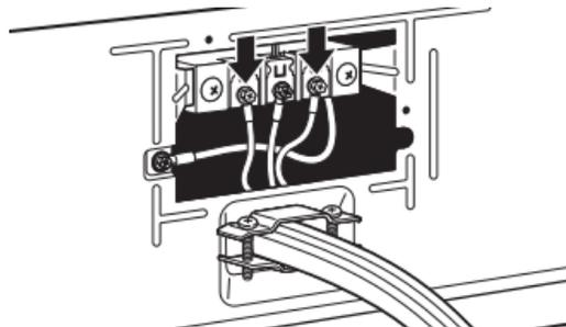
Connecter les conducteurs restants sous les vis les plus à l'extérieur du bornier. Serrer les vis. Placer la languette du couvercle du bornier dans la fente du panneau arrière de la sécheuse. Fixer le couvercle avec la vis de retenue. Ensuite, aller à la section « Exigences concernant l'évacuation ».
