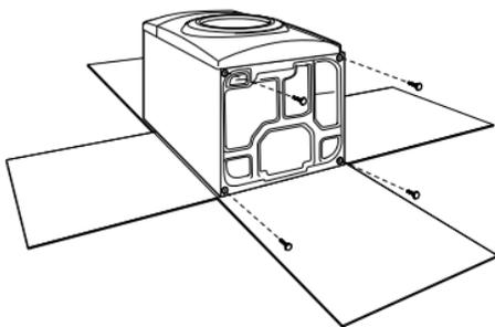
Afin d'éviter d'endommager le plancher, utiliser un grand morceau de carton plat extrait de la boîte d'emballage de la sécheuse et le placer sous toute la partie arrière de la sécheuse. Saisir fermement le corps de la sécheuse (et non pas le panneau de la console), puis poser la sécheuse sur le carton avec précaution.
