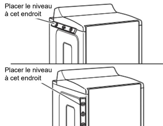
Vérifier l'aplomb de la sécheuse dans le sens transversal. Répéter l'opération dans le sens avant-arrière.
