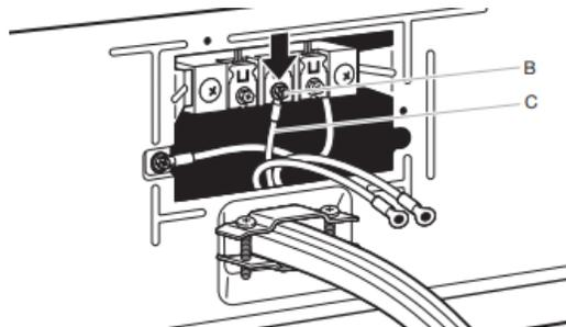
Connecter le conducteur neutre (blanc ou central) (C) du câble d'alimentation sous la vis de la borne centrale (B). Serrer la vis.
