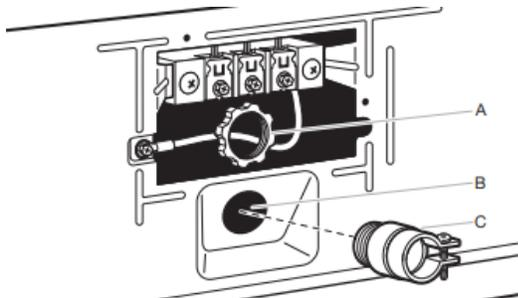
Dévisser le raccord de conduit amovible (A) et les vis d'un serre-câbles homologué UL (inscription UL sur le serre-câbles) de 3/4 po (19 mm). Visser la partie filetée du serre-câbles dans le trou sous l'ouverture du bornier (B). En passant par l'ouverture du bornier, visser le connecteur de conduit amovible (A) sur le filetage du serre-câbles (C) et bien serrer.
