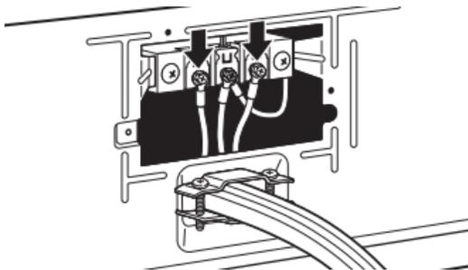
Placer les conducteurs restants sous les vis les plus à l'extérieur du bornier. Serrer les vis.
