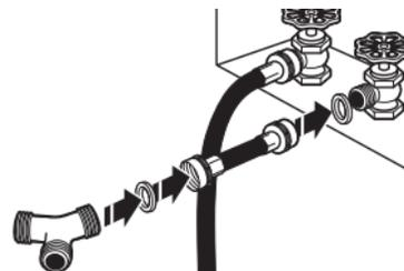
Fixer le tuyau d'alimentation de 2 pi (0,6 m) au robinet d'eau froide. Visser le raccord à la main pour qu'il repose sur le robinet. Fixer le raccord en « Y » à l'extrémité mâle du tuyau d'alimentation de 2 pi (0,6 m). Visser le raccord à la main jusqu'à ce qu'il repose sur le raccord.
