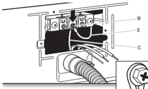
Connecter le conducteur neutre (E) et placer le crochet d'extrémité (crochet vers la droite) du conducteur neutre (blanc ou central) (C) du câble à raccordement direct sous la vis de la borne centrale (B). Rapprocher les extrémités du crochet et serrer la vis.
