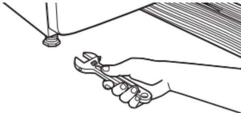
Si la sècheuse n'est pas d'aplomb, la relever à l'aide d'un bloc de bois. Utiliser une clé pour ajuster les pieds vers le haut ou vers le bas, et vérifier à nouveau si elle est d'aplomb.
