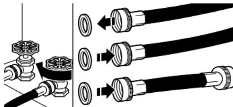
Fermer le robinet d'eau froide et ôter le tuyau d'alimentation de la laveuse. Retirer l'ancienne rondelle en caoutchouc du tuyau d'arrivée d'eau et la remplacer par la nouvelle rondelle en caoutchouc.
