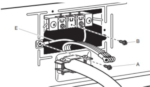
Retirer la vis de la borne centrale (B). Retirer le conducteur neutre (E) de la vis du conducteur de terre externe verte (A).
