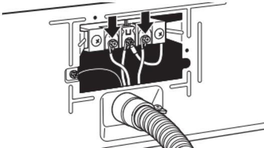
Placer les extrémités en crochet des conducteurs restants du câble pour raccordement direct sous les vis les plus à l'extérieur du bornier (crochets vers la droite). Rapprocher les extrémités du crochet et serrer la vis. Placer la languette du couvercle du bornier dans la fente du panneau arrière de la sècheuse. Fixer le couvercle avec la vis de retenue. Ensuite, aller à la section « Exigences concernant l'évacuation ».
