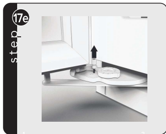
Remove door stop pin
