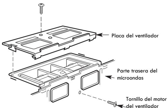
Quite el tornillo que sujeta la placa del ventilador al microondas. Quite y guarde el tornillo que sujeta el motor del ventilador al microondas.
