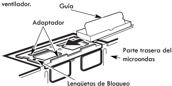
Empuje hacia adentro hasta que encaje en las lengüetas de bloqueo inferiores. Tenga cuidado de asegurarse de que la bisagra del regulador de extracción esté instalada de manera que quede movable libremente.
