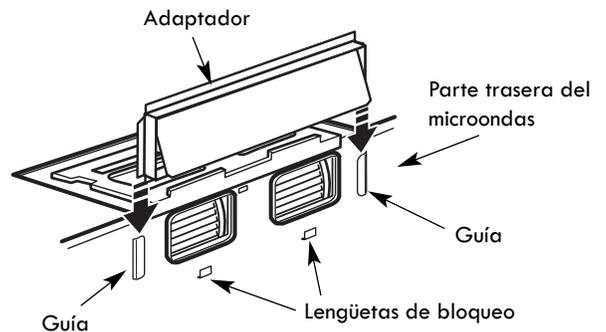
Empuje hacia adentro hasta que encaje en las lengüetas de bloqueo inferiores. Tenga cuidado de asegurarse de que la bisagra del regulador de extracción esté instalada de manera que quede en la parte superior y que se pueda mover libremente.
