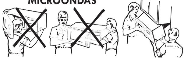
POR RAZONES DE SEGURIDAD PERSONAL Y PARA FACILITAR LA INSTALACIÓN, SE RECOMIENDA QUE **DOS PERSONAS INSTALEN EL HORNO MICROONDAS.**
