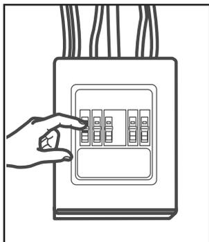
**PRECAUCIÓN:** por razones de seguridad personal, antes de comenzar con el procedimiento de instalación, retire el fusible correspondiente o desconecte el disyuntor doméstico, a fin de evitar cualquier lesión personal causada por un choque eléctrico.
