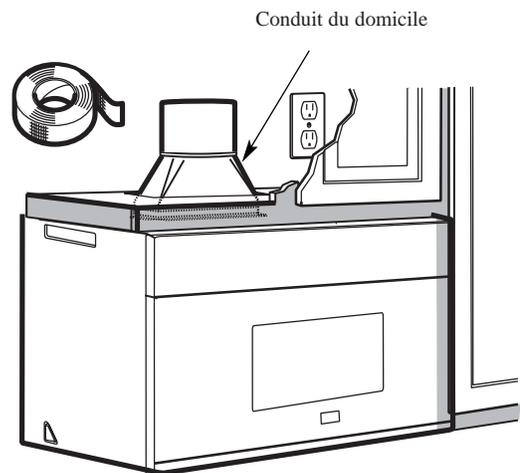
1 Tirez sur le conduit du domicile pour le raccorder à l'adaptateur d'évacuation.
