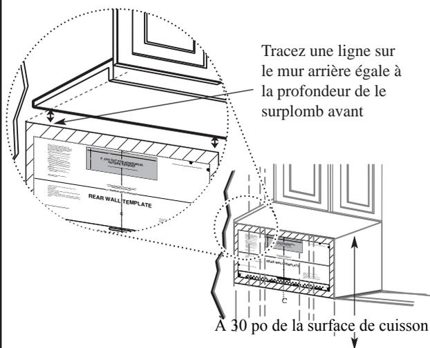
Tracez une ligne sur le mur arrière égale à la profondeur de le surplomb avant
