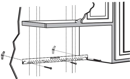
Fije la placa en la pared con los tornillos de fijador. Al menos un tornillo para madera debe ser utilizado para fijar la placa a una viga de la pared.
