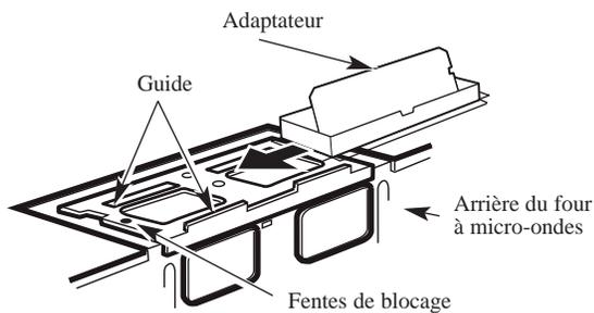
Insérez-le jusqu'à ce qu'il soit dans les fentes de blocage inférieures. Assurez-vous que la charnière du registre est installée et que le registre bouge librement.
