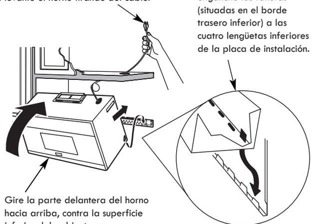
**2** Gire la parte delantera del horno hacia arriba, contra la superficie inferior del gabinete.
