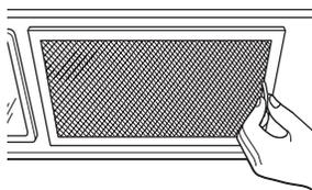
7 Instale los filtros de grasa. Consulte el Manual del usuario provisto con el microondas.
