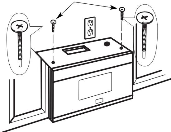
6 Apriete los dos tornillos externos a la parte superior del horno. (Mientras aprieta los tornillos, mantenga sujeto el horno contra la pared y el gabinete superior)
