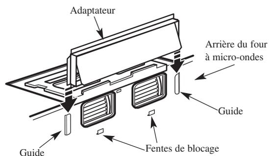
Insérez-le jusqu'à ce qu'il soit dans les fentes de blocage inférieures. Assurez-vous que la charnière du registre est installée sur le dessus et que le registre bouge librement.
