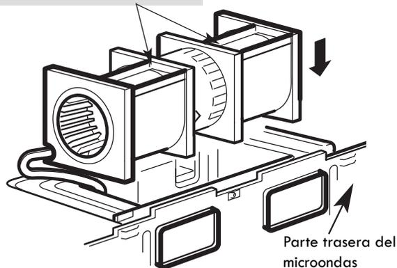
**PRECAUCIÓN:** No tire hacia afuera ni estire los cables del ventilador. Asegúrese de que los cables no queden atrapados y que queden debidamente asegurados.
