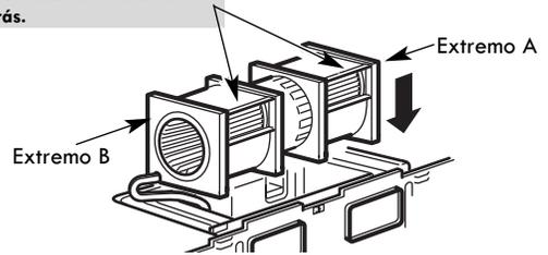
**PRECAUCIÓN:** No tire hacia afuera ni estire los cables del ventilador. Asegúrese de que los cables no queden atrapados y que queden debidamente asegurados.
