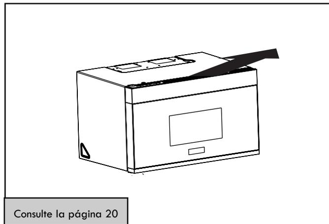
Los modelos fabricados para un sistema de extracción basado en la recirculación del aire vienen con la instalación de fábrica de un filtro de carbón, el cual ayuda a eliminar el humo/los vapores y los olores.
