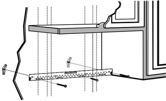
Fije la placa en la pared con los tornillos de fiador.
