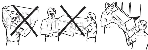
POR RAZONES DE SEGURIDAD PERSONAL Y PARA FACILITAR LA INSTALACIÓN, SE RECOMIENDA QUE **DOS PERSONAS INSTALEN EL HORNO MICROONDAS.**
