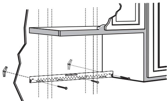
Fixez la plaque au mur à l'aide des boulons à ailettes. Vous devez utiliser au moins une vis à bois pour fixer la plaque à un montant.
