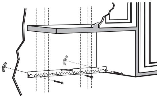
Fije la placa en la pared con los tornillos de fiador. Al menos un tornillo para madera debe ser utilizado para fijar la placa a una viga de la pared.
