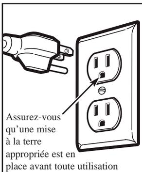
Pour diminuer les risques de choc électrique, le cordon d'alimentation de cet appareil est muni d'une fiche à trois broches (mise à la terre) qui correspond à une prise murale à trois alvéoles, mise à la terre.
