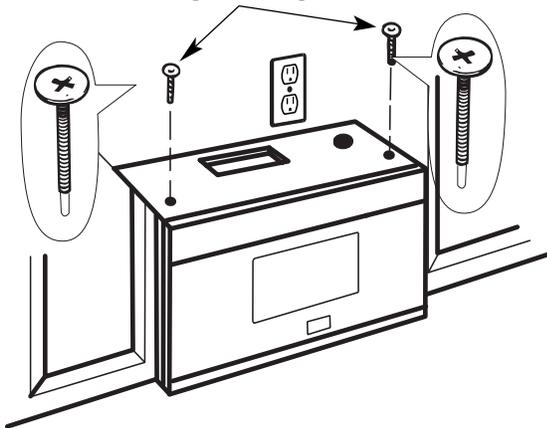
7 Serrez les deux vis de chaque côté dans le dessus du four à micro-ondes. (Tout en serrant les vis, soulevez l'avant du four à micro-ondes et poussez-le contre le mur et l'armoire supérieure.)
