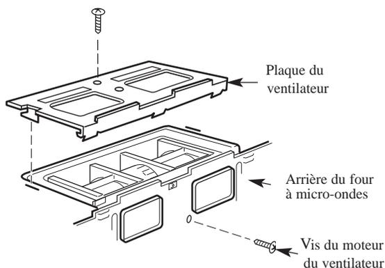
Enlevez la vis qui retient la plaque du ventilateur sur le four à micro-ondes. Enlevez et conservez la vis qui retient le moteur du ventilateur sur le four à micro-ondes.
