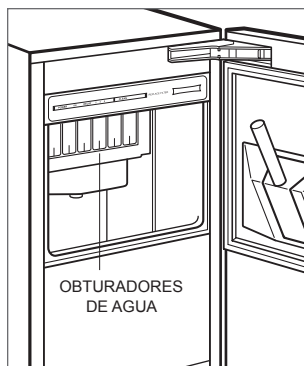
Ubicación de los obturadores de agua
