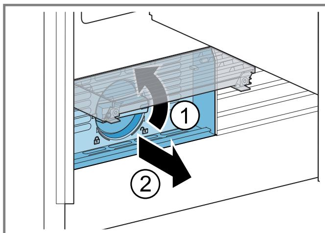
**Nota:** Goteará un poco de agua al retirar el filtro. Eliminar el agua que ha goteado con un paño seco.
