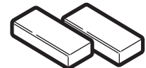
Bloques de relleno o pedazos de madera de desecho, si es necesario para el espacio del gabinete superior (usado solo en instalaciones de gabinetes inferiores empotrados)
