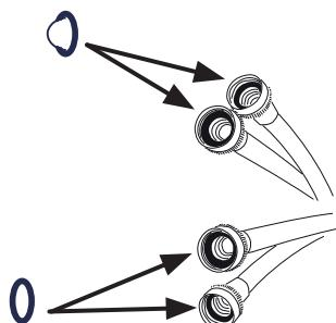
2. Apriete los accesorios de la manguera y el grifo a mano hasta que estén ajustados, luego apriételos dos tercios de un giro adicional con una pinza o una llave inglesa. Tire de las mangueras de suministro de agua hacia abajo para asegurar que estén conectadas de forma segura.
