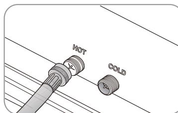
**NOTA:** Si no desea utilizar la manguera de suministro de agua caliente, inserte una tapa de entrada de agua en el orificio de admisión de agua caliente. En este caso, debe seleccionar la opción Tap Cold (Fría del grifo) para la temperatura del agua.
