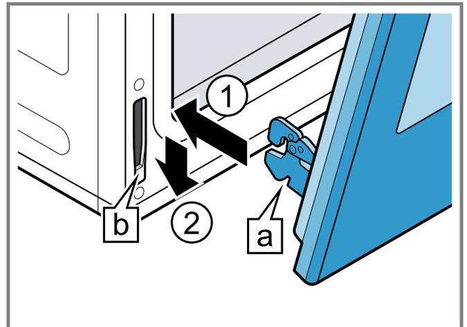
L'angle de la porte peut nécessiter un léger ajustement pour permettre d'engager les charnières convenablement et d'abaisser la porte en place. La porte devrait s'abaisser d'environ 3/4 po (2 cm) et s'arrêter. Si ce n'est pas le cas, les charnières ne se sont pas engagées correctement et la porte pourrait tomber si elle était libérée.
