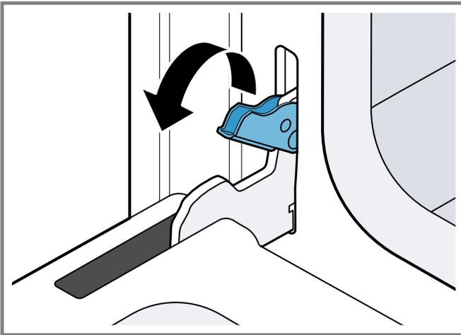
Si nécessaire, utilisez un outil, tel qu'un tournevis, pour retirer délicatement la partie supérieure du levier du boîtier. Veillez à ne pas rayer le boîtier.
