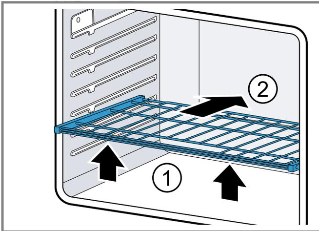
**Remarque :** Éviter de percuter la lentille de protection de l'éclairage du four en enfonçant la grille dans la cavité pour la mettre en place.
