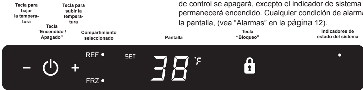
Figura 12a Control electrónico para una sola zona
