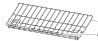
A. Parrilla de vapor B. Depósito de agua
