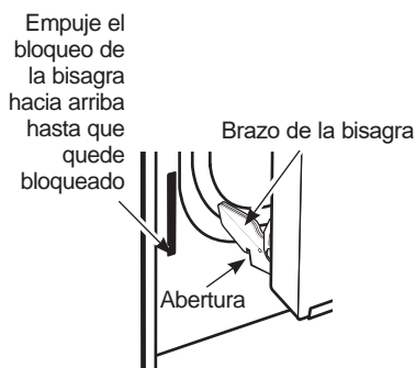
Empuje el bloqueo de la bisagra hacia arriba hasta que quede bloqueado Apoye la abertura en el extremo inferior de la ranura de la bisagra
