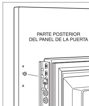
Montaje del panel de la puerta
