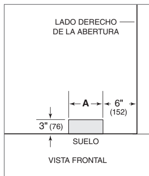
Ubicación del suministro de agua (parte posterior)
