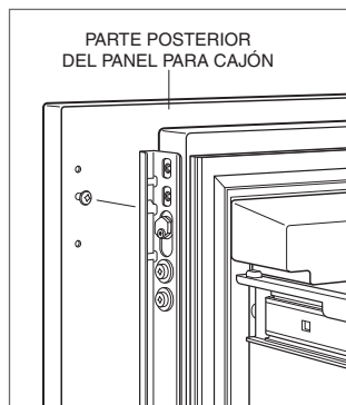
Montaje del panel del cajón
