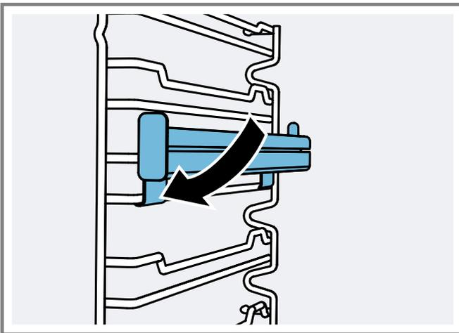
3. Faites glisser la partie mobile du rail télescopique vers l'intérieur et l'extérieur plusieurs fois pour vous assurer qu'elle peut se déplacer librement et que la partie fixe du rail télescopique est solidement ancrée.
