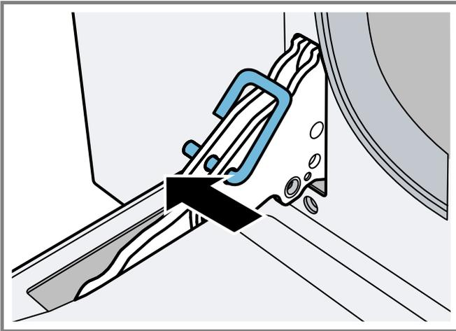
3. **⚠ MISE EN GARDE** Déplacez lentement la vitre pour éviter d'endommager la vitre et le cadre de la cavité du four.
