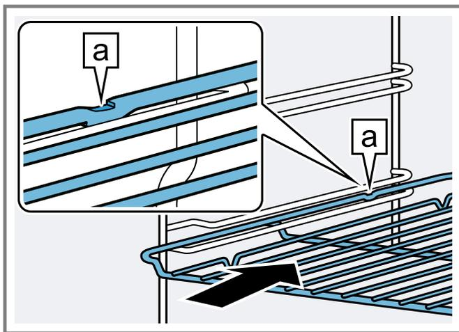
3. Inclinez la grille vers le haut pour permettre à la butée de glisser sur le guide de grille.
