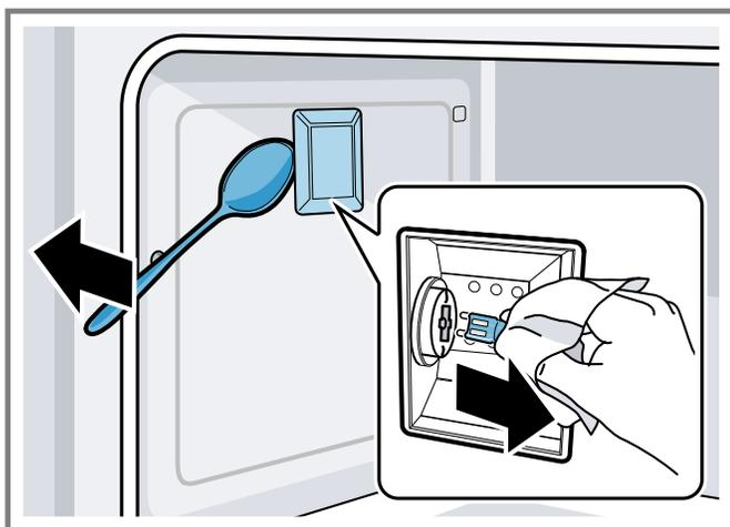
7. Remplacez l'ampoule du four par une ampoule du même type.
