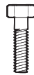
Tirafondo o perno de expansión con camisa de ½ pulgada (diámetro exterior)
