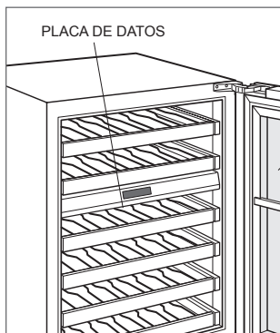
Ubicación de la placa de datos (modelo de 24")
