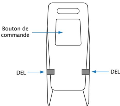
Le centre de commande est généralement situé sur la partie supérieure du pare-brise avant. Ses composants sont les suivants :
