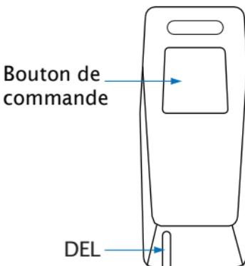
Le Centre de commande est généralement situé dans la partie supérieure du pare-brise avant. Ses composants sont les suivants :
