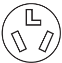
Tomacorriente de 3 hilos (10-30R)
