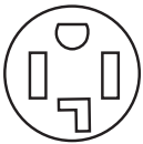
Tomacorriente de 4 hilos (14-30R)
