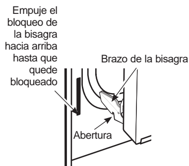
Empuje el bloqueo de la bisagra hacia arriba hasta que quede bloqueado Apoye la abertura en el extremo inferior de la ranura de la bisagra
