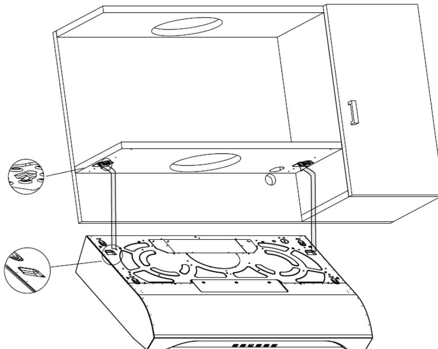
5. Accrocher la hotte en fixant les 4 vis ST 3/16 po x 11/16 po (vis à tête fraisée) dans les fentes.
