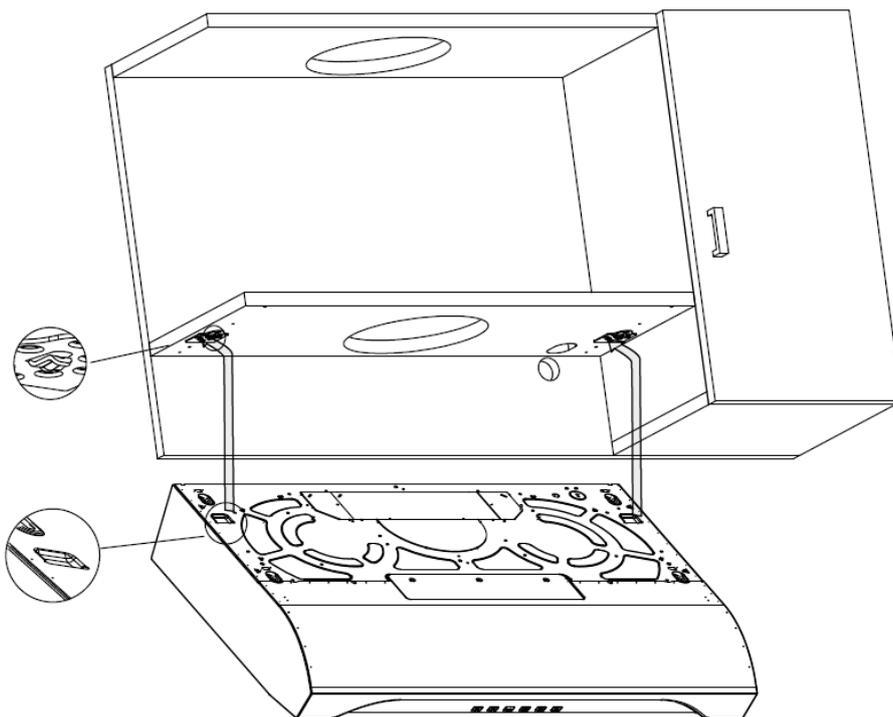
4. Tout en retenant la hotte, acheminez le câble d'alimentation électrique jusqu'à l'intérieur de la hotte à travers le serre-fils installé précédemment.
