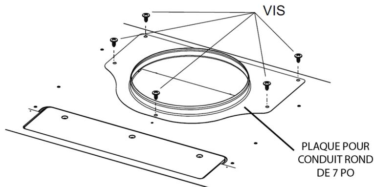
**TRUC** : Glisser une petite longueur de conduit par-dessus l'adaptateur/volet de 3¼ po x 10 po, de 3 ¼ po x 14 po (pour un conduit rectangulaire) ou de 7 po rond (pour un conduit rond) et sceller le joint à l'aide de ruban adhésif d'aluminium pour faciliter le raccord avec le reste des conduits.
