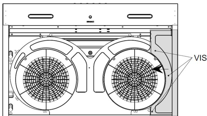
4. Utiliser le tournevis Phillips pour retirer les 3 vis du conduit rond de 7 po. Retirer le conduit rond de 7 po.
